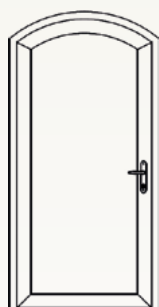
Porte cintre surbaissé
